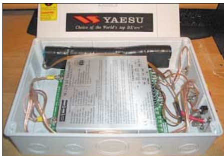
Bild 1: Der Hensel -Kasten bietet Platz für den SG-239 und Akkumulatorpack.
